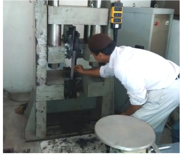
Universal Testing Machine দ্বারা মাটি রড করা হচ্ছে।
