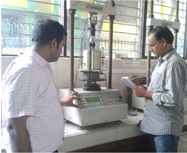
Laboratory তে CBR Test করা হচ্ছে।
