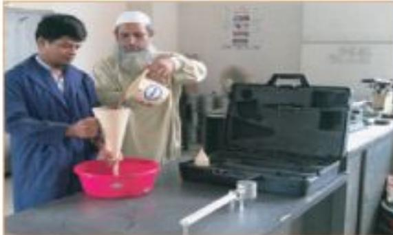
আলোকচিত্র-৫২ : Drilling Fluid এর Viscosity Test করা হচ্ছে।
